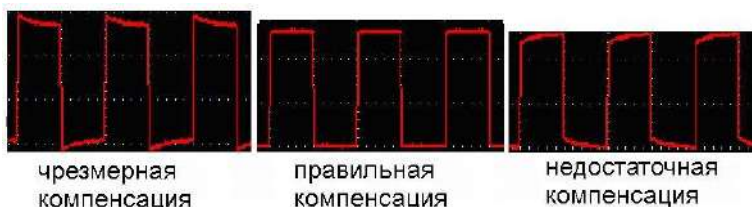
Рисунок 10 - Варианты осциллограммы при компенсации щупа
